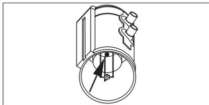
5. Setzen die Filterkartusche wieder ein und schrauben sie die Stellschraube fest.
