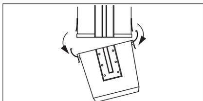
3. Entleeren Sie den Staubbehälter oder tauschen Sie den Plastiksack aus.
