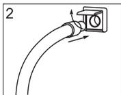
2) Öffnen Sie den Deckel der Saugdose und führen Sie das Metallteil des Saugschlauches in die Dosenöffnung ein.
