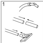
1) Befestigen Sie das für den jeweiligen Reinigungszweck geeignete Zubehöerteil am vorderen Ende des Saugschlauches oder des Saugrohres.
