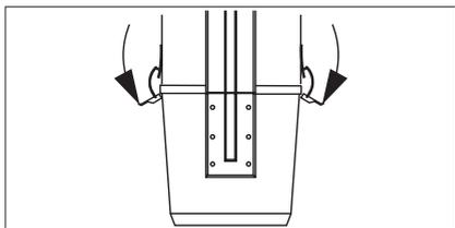
5. Schließen Sie die Befestigungsklammern am Chassis des Gerätes und achten Sie auf die perfekte Überlappung zwischen Chassis-Rille und Staubbehälterrand, um Lufteintritt und Saugkraftverluste zu vermeiden. Schließen Sie beide Befestigungsklammern gleichzeitig.
