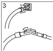
3a) Bei Saugdosen mit Mikroschaltern schaltet sich die Anlage bei Öffnung der Saugdose ein.
