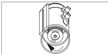
6. Befestigen Sie den Staubbehälter wieder mit Hilfe der Befestigungsclammern am Chassis des Gerätes und achten Sie auf die perfekte Überlappung zwischen Chassis-Rille und Staubbehälterrind, um Lufteintritt und Saugkraftverluste zu vermeiden. Schließen Sie beide Befestigungsclammern gleichzeitig.
