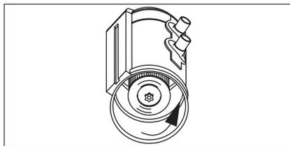
3. Reinigen Sie den Polyesterfilter durch Schütteln, bzw. leichtes Ausklopfen, Drucklufteinwirkung oder Absaugung mittels eines konventionellen Staubsaugers oder mit klarem Wasser abwaschen. Achten Sie dabei darauf, das Filtermaterial nicht zu beschädigen.
