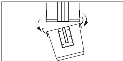
2. Drehen Sie den Drehknopf gegen den Uhrzeigersinn, bis sich der Filter lockert.
