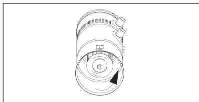
3. Reinigen Sie den Filter durch Schütteln, bzw. leichtes Ausklopfen, Drucklufteinwirkung oder Absaugung mittels eines konventionellen Staubsaugers. Achten Sie dabei darauf, das Filtermaterial nicht zu beschädigen.
